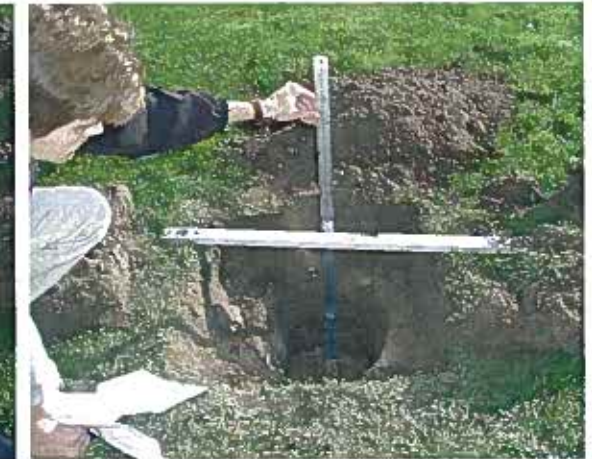
Måling af jordens infiltrationsevne. Der lægges en retningskinne over hullet, og herfra måles nedstik til vandoverfladen.
