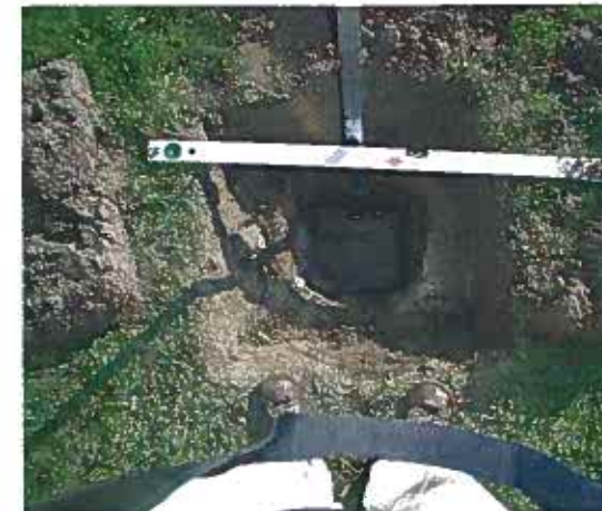
Hvis vandspejlet synker mere end 0,2 m på 15 min. fortsættes vandmætningen til synkehastigheden er næsten konstant.
