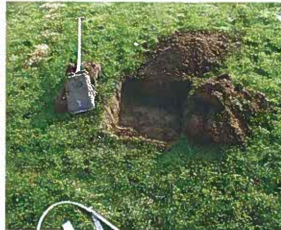
Prøvehul skal være min. 0,25 m x 0,25 m og mindst 0,3 m dybt.
