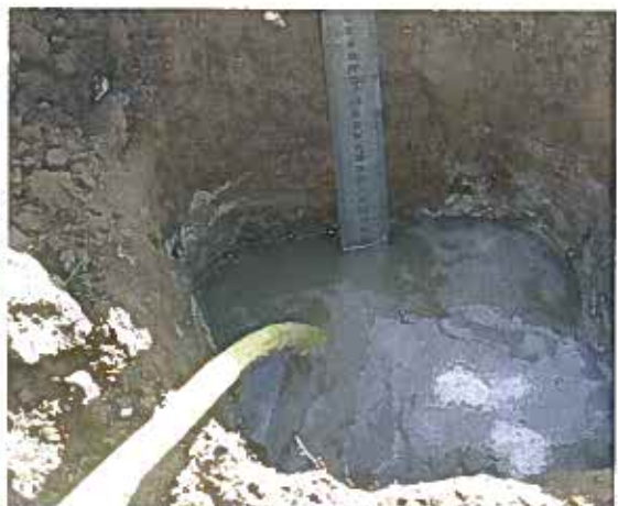
Synkehastighed måles. Hvis vandspejlet synker mindre end 0,2 m på 15 min. kan infiltrationstesten begynde.
