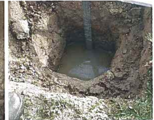
Synkehastigheden omregnes til m/s. Herefter kan testen afsluttes, og hullet tildækkes.
