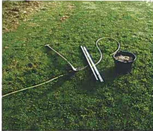
Udstyr til infiltrationstest: Haveslange, skovl, grus, retningsskinne og målestok/målebånd.
