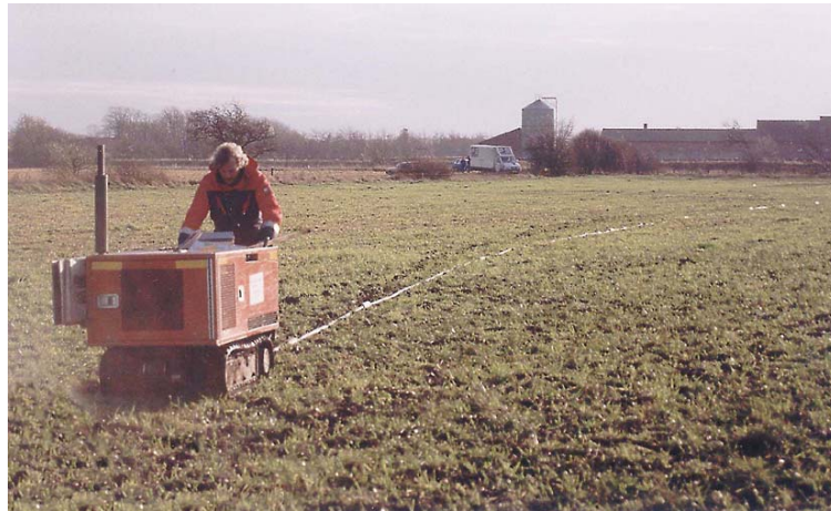
Figur 1. Billede af måleudstyret. Arbejdet i marken efterlader normalt kun svage spor. Udstyret betjenes af to personer til fods.
