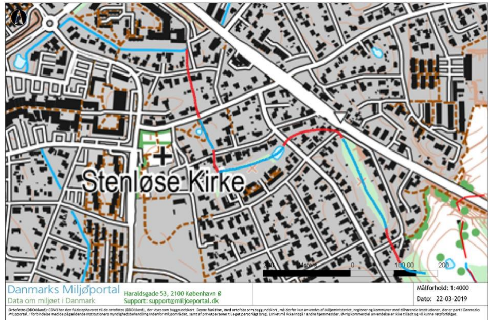
Figur 4.9: Forslag til linjeføring af en overløbsforbindelse Stenløse Å og Helledemosen.
