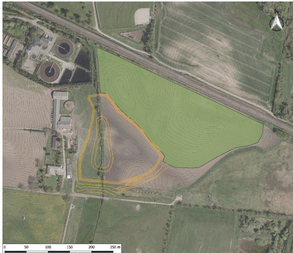
Figur 6.34: Illustration der viser jordbearbejdning i området med 0,5 m kurver. Det grønne område indikerer et område, hvor overskudsjord fra etablering af bassinet kan placeres på terrænet i et jordudlæg på 30 cm.
