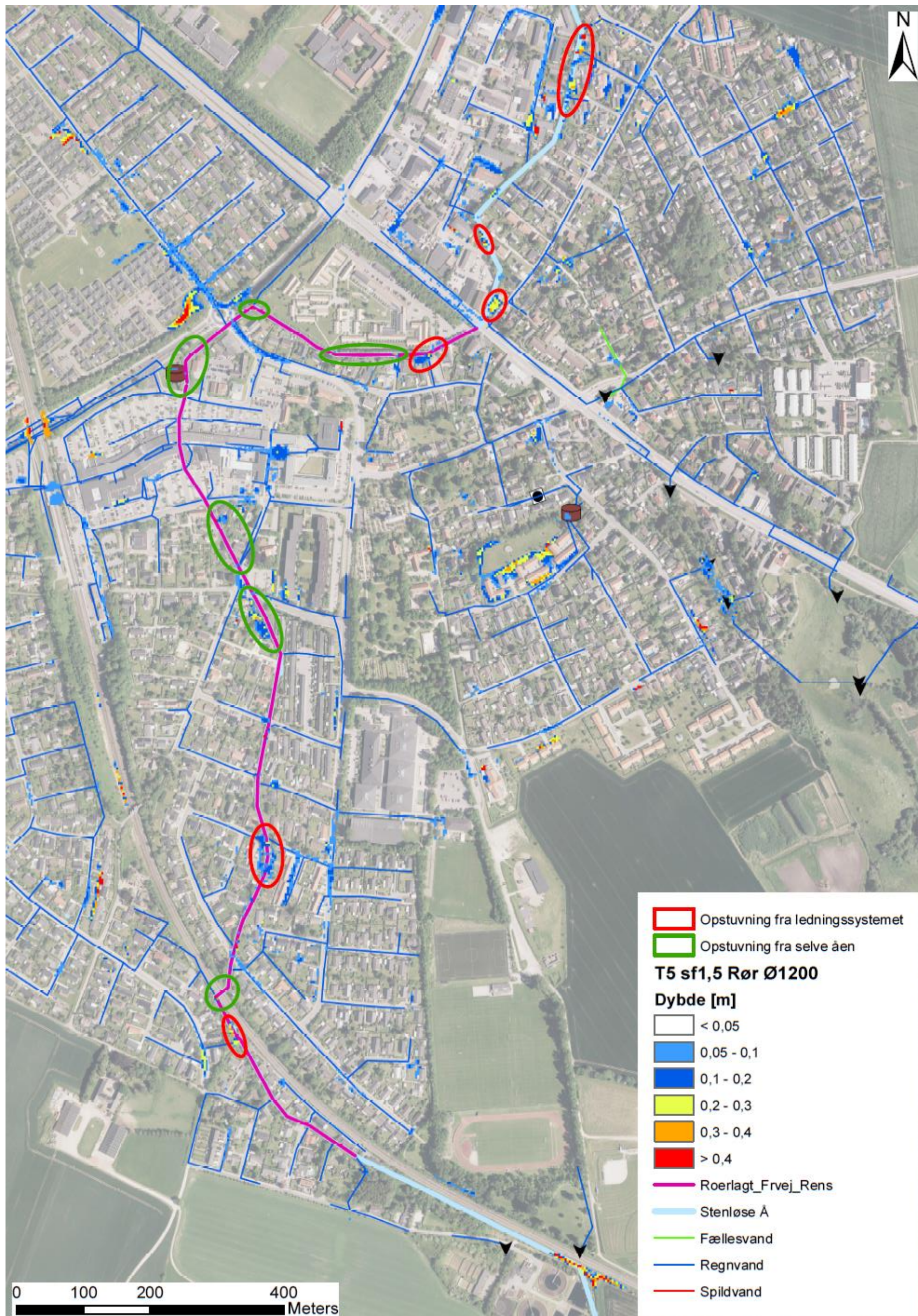
7.10 Bilag 10: Oversvømmelseskort for scenarie c – rørlagt med Ø1200 for en 5 års hændelse.
