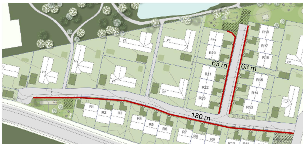
Figur 5.10: Placering af grøfter med opmålte længder i Scalgo /6/.
