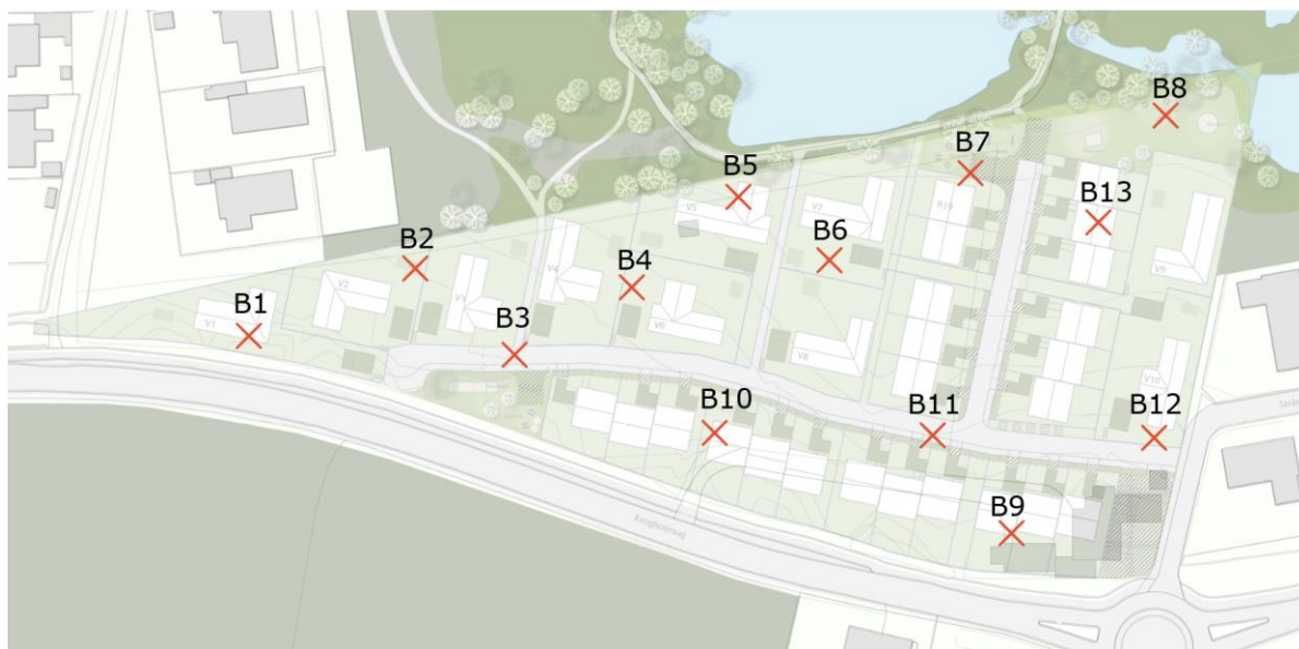
Figur 4.1: Placering af geotekniske boringer /6//7/
