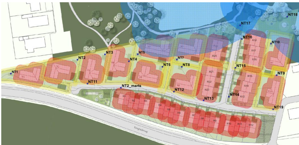
Figur 5.1: Angivelse af regnbedenes placering, samt placering af nedsivningstest. Bufferzoner for afstandskrav; Gul: 2 m til skel, Rød: 5 m til bygning, Blå 25 m til sø /1/.
