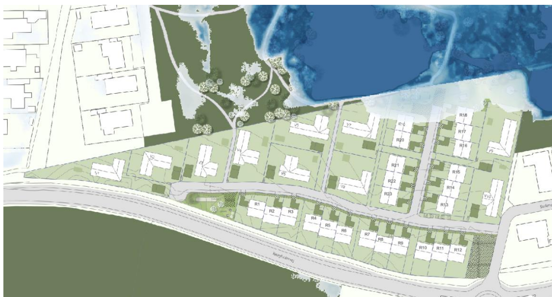
Figur 6.2: Situationsplan med bluespot for en maksimal vandstand på grunden /8/.
