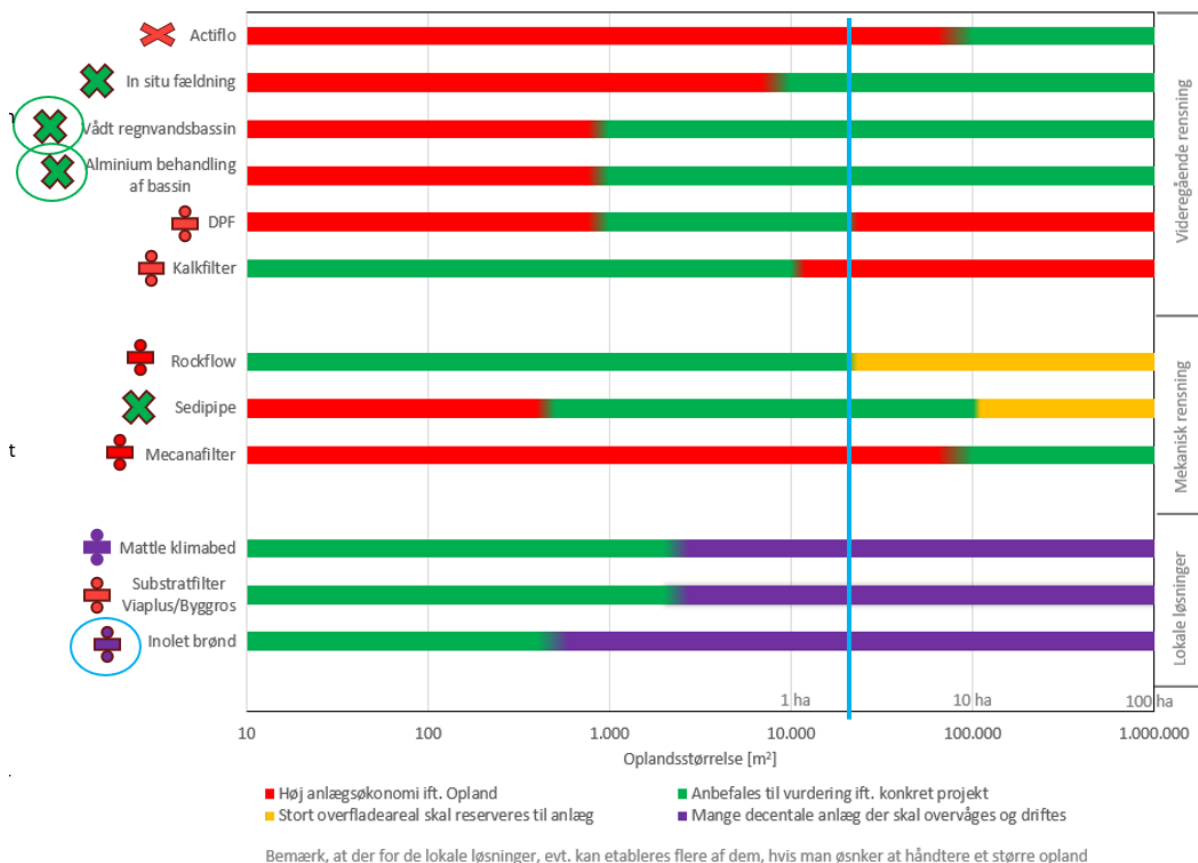
Figur 14 Skema for valg af videregående rensning på Bassin U24 med et opland på ca. 2,8 ha red (blå lodret linje). X med en grøn ring udpeger den primære rensningsmetode mens blå ring udpeger løsninger som der senere kan suppleres med hvis den primære rensningsstrategi ikke er tilstrækkelig effektiv
