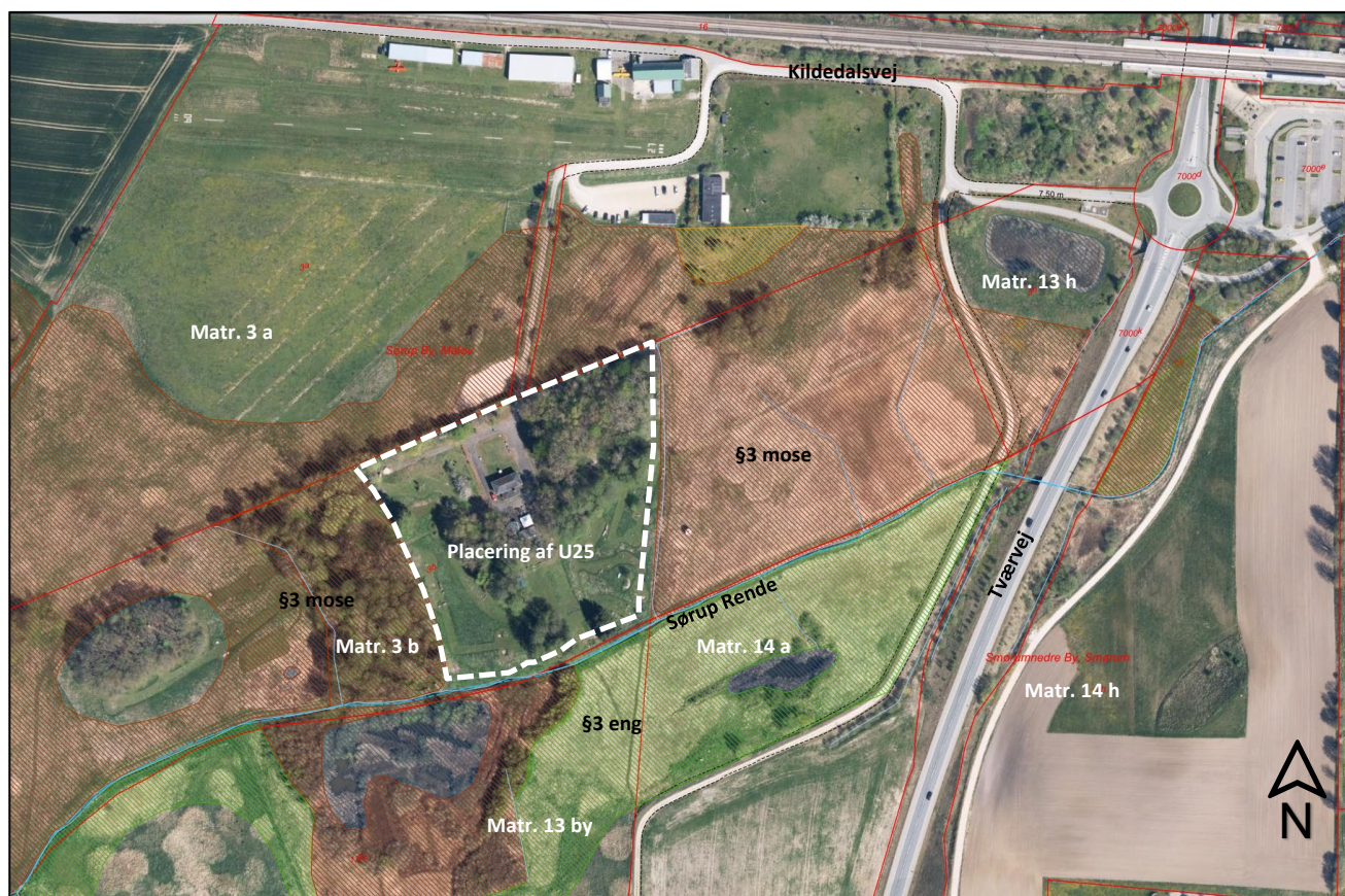
Figur 5 Bassin U25 placeres nord for Sørup Rende hvor der under eksisterende forhold er adgang fra Kildedalsvej i nord. Området er mod nord, øst og vest omkranset af §3-beskyttet mose.
