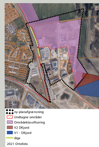
Figur z - jordforurening og beplantet dige. Rød: V2 kortlagt forurening Blå: V1 kortlagt forurening Lilla: Områdeklassificering Gul streg: Beplantet dige. Rød skravering: Undtaget
