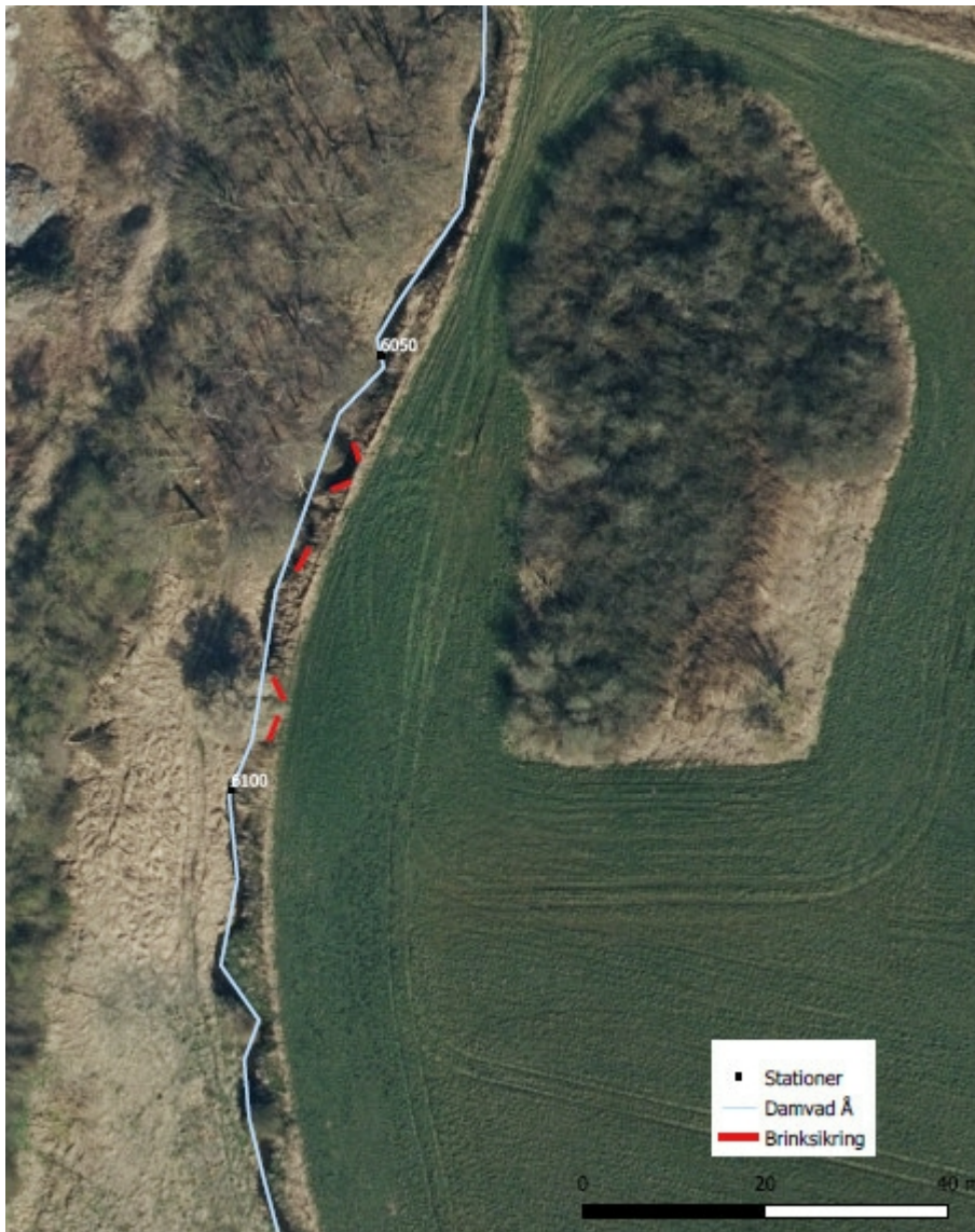
Figur 2. Tegning hvor brinksikringen ønskes laves. Bemærk at, at de røde markeringer følger vandløbet, og at disse markeringer blot viser hvor brinksikringen skal laves og ikke er retvisende med målestoksforholdet.
