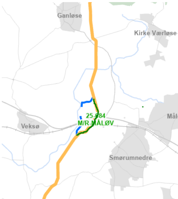
Figur 1.1 Placering af projektet. Eksisterende gastransmissionsledning (orange streg), ny ledning (blå-orange stiplede streg) og strækning, hvor dele af eksisterende ledning skal fjernes (grøn streg)
