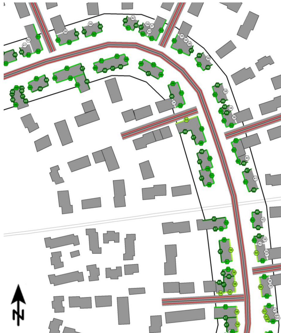
Figur 8: Beregnet støjbelastning på projektets facader, vist som L_{den} i dB ved den mest udsatte etage
