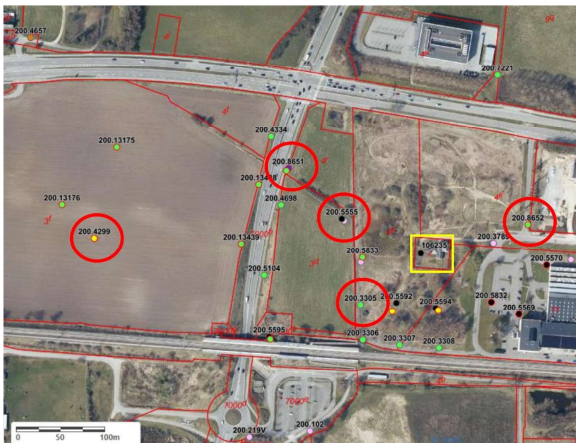
Figur 4.16: Afværgeanlæg på Cheminovagrunden markeret med gul firkant (AnlægsID 106235) og de fem afværgeboringer markeret med rød ring (WSP, 2022). Se også Figur 4.17.
